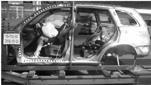
(b) 坐盆安全气囊起爆后
