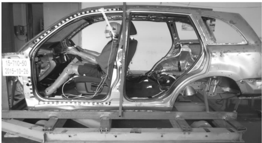
(a) 坐盆安全气囊起爆前
